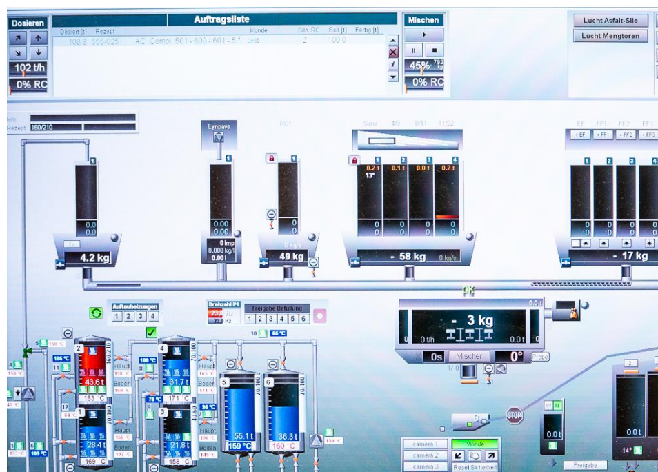
Figuur 5: Illustratie van besturingssysteem bij asfaltmenginstallatie
