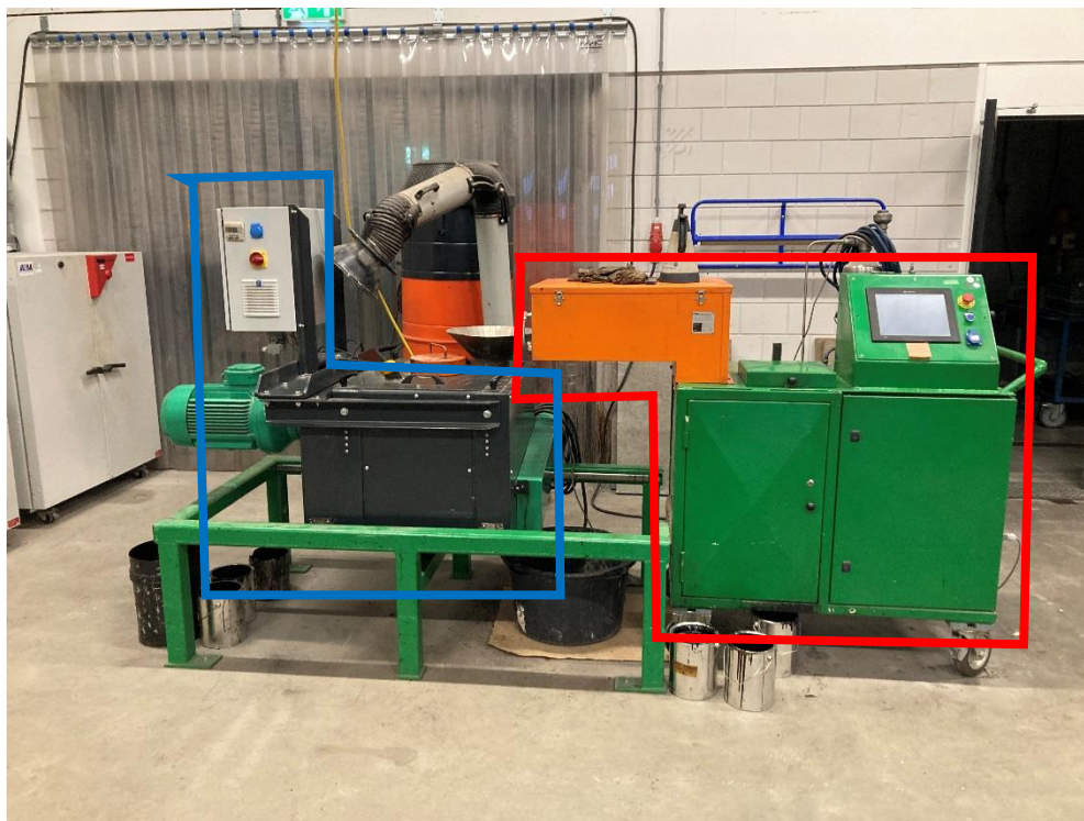
Figuur 3: LEAB productie-unit in het laboratorium (blauw = menger, rood is schuimunit)
