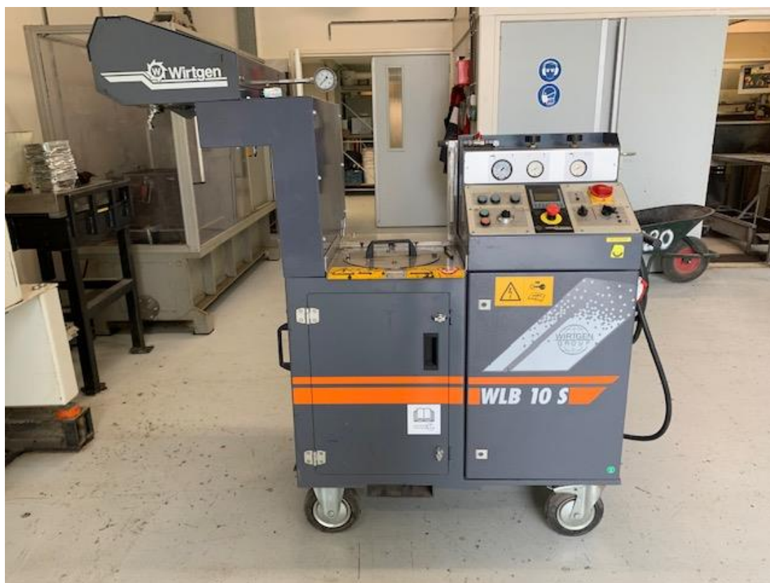
Figuur 4: Wirtgen WLB 10S laboratorium schuimunit
