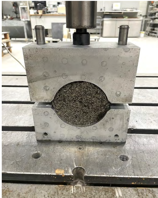
Figuur 3.5 Voorbeeld van een Marshall test.
