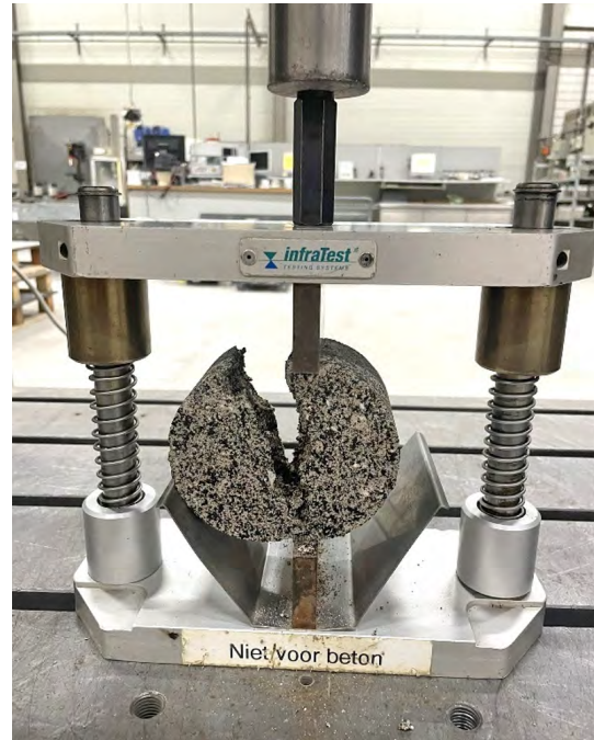
Figuur 3.6 Voorbeeld van onderzoek naar indirecte splijtsterkte (ITS).
