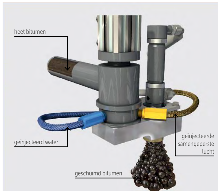
Figuur 3.3 Schuimbitumen uit laboratorium schuimunit.
